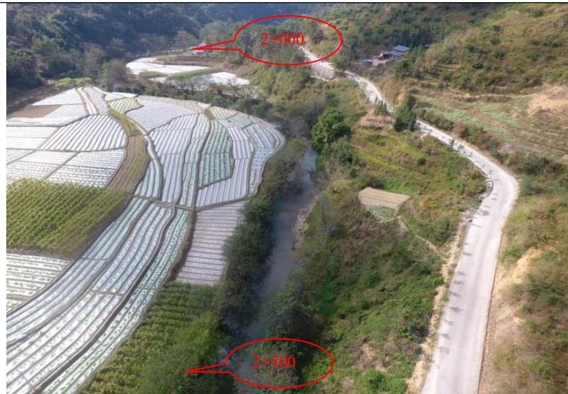
本段只针对有农田保护的河岸进行治理，荒坡河岸维持原状。治理措施采用固滨笼护脚，雷诺垫护坡，并在堤顶修建混凝土道路。由于岸坡陡缓变化较大，护坡坡比根据岸坡地形在 1:1~1:1.8 之间选择，满足稳定即可。
